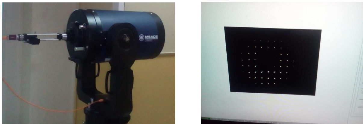
Рис. 2. а) Внешний вид макета измерителя с ДВФ. б) Полученная гартмограмма.
