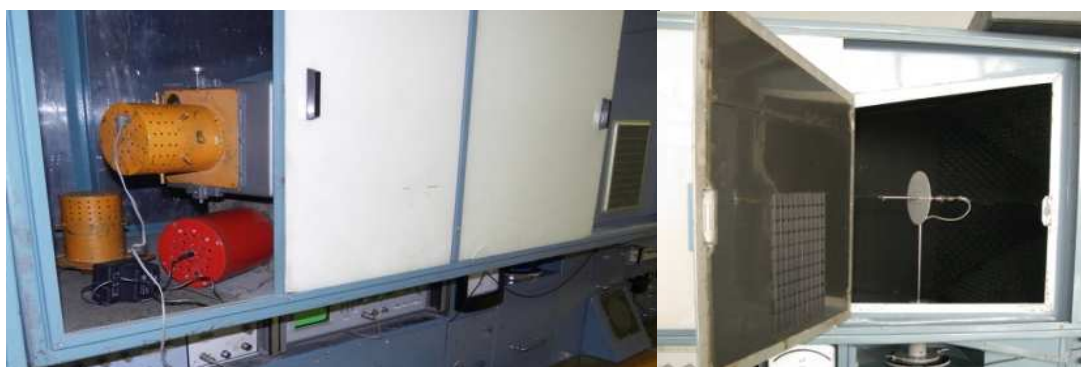
Рис. 3. Измерительный стенд на базе безэховой камеры (БЭК). Слева: открыт генераторный блок БЭК. Справа: открыт измерительный блок БЭК с установленной в нем антенной. Внутренность БЭК покрыта радиопоглощающим материалом.
